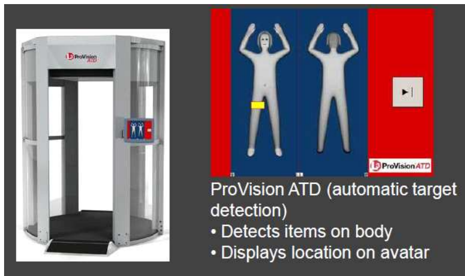
[그림 2-2] L3 시스템의 Automatic Target Detection Concept(출처: L3 SDS)
